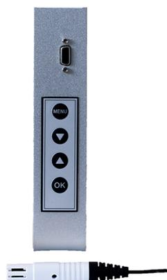
El rango de medida de estos termómetros de gran formato va de -40 a 85°C de temperatura y de 0 a 100% de humedad relativa con una precisión de  $\pm 0,5^\circ\text{C}$  y  $\pm 5\%$  respectivamente.
